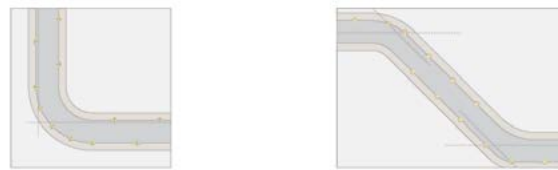
Disposición de luminarias en tramos curvos
